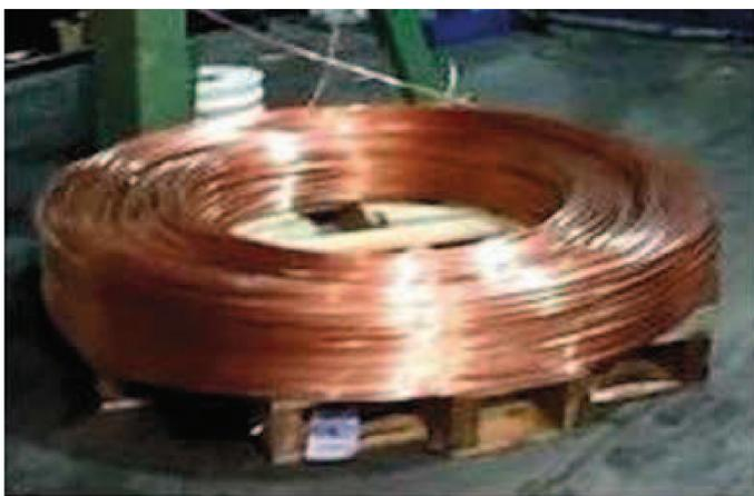
**Copper Rod  $\varnothing$  8 mm**
