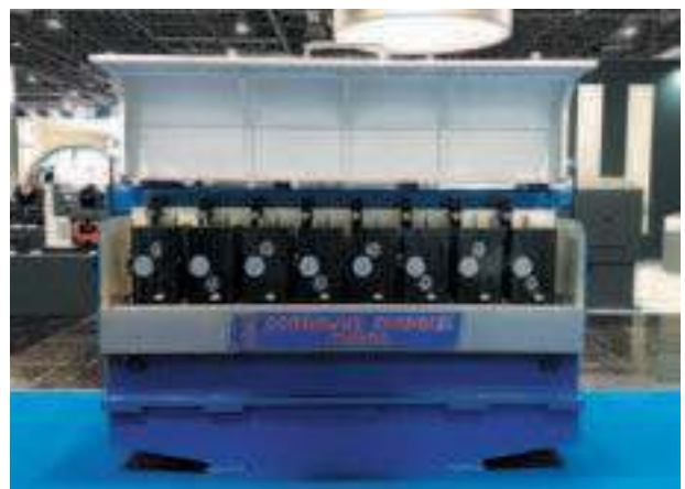
Проперци Микророллинг® стан для производства сварных труб, используемый для метода самоотжигания Микророллинг®
