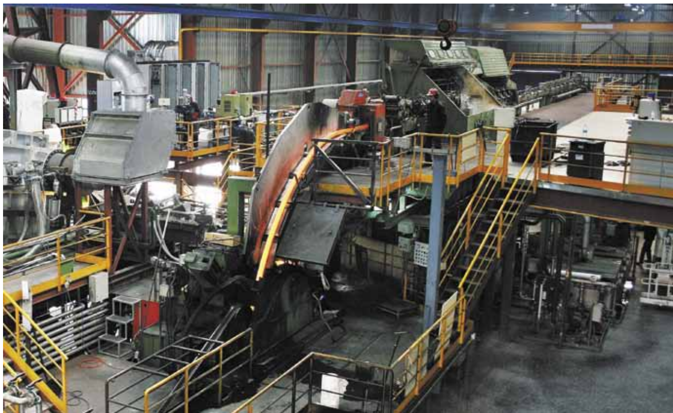
Современная Линия по производству медной катанки от печного комплекса до системы автоматической намотки
