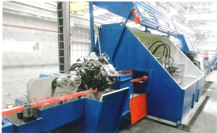
(sopra) CCR CU FRHC Line per la produzione di vergella di rame da rottami.
